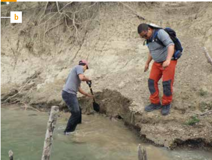
Figura 4.2: Muestreo manual de los sedimentos del Usumacinta: (a) con cono, (b) con pala, (c) con cubo. © I. Djeran-Maigre, abril 2018.
