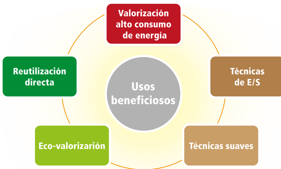
Figura 10.4: Técnicas de valorización de los sedimentos. E/S: Estabilización/Solidificación. © D. Levacher.
