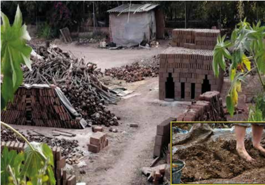
Figura 1.2: Elaboración de ladrillo rojo artesanal: adobe, ladrillo y teja. Se observa el barro incorporado a materiales vegetales secos y arcilla para la producción de ladrillos. © U. Rodríguez Robles.
