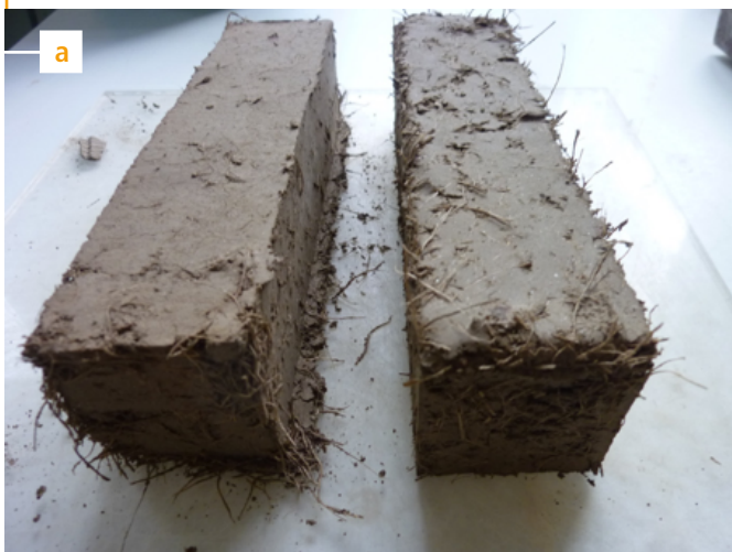
Figura 10.5 a: Ladrillos de sedimentos crudos del Usumacinta (Jonuta, Tabasco, México) reforzados con fibras de palma de aceite. © D. Levacher.
