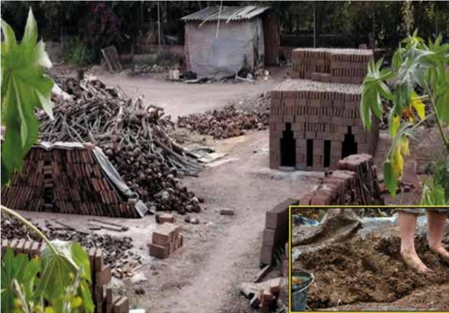
**Figura 1.2:** Elaboración de ladrillo rojo artesanal: adobe, ladrillo y teja. Se observa el barro incorporado a materiales vegetales secos y arcilla para la producción de ladrillos.
