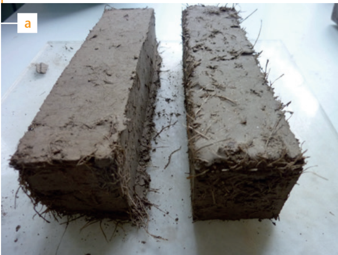
Figure 10.5 a : Briques crues de sédiments de l'Usumacinta (Jonuta, Tabasco, Mexique) renforcées de fibres de palmier à huile. © D. Levacher
