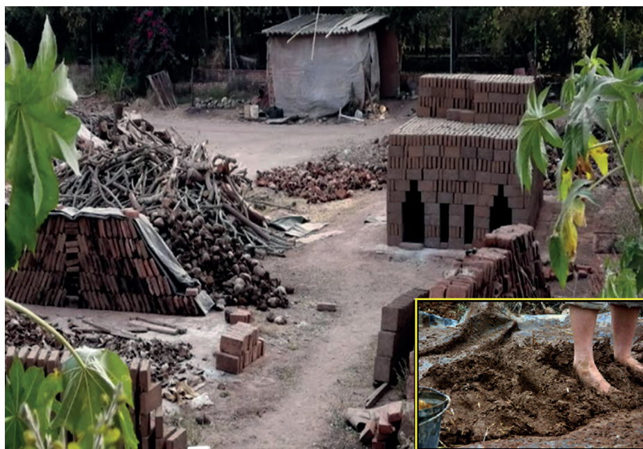
Figure 1.2 : Atelier artisanal de briques rouges : adobe, brique et tuile. L'image montre la boue incorporée à partir de matières végétales séchées et d'argile pour la production de briques. © U. Rodriguez Robles
