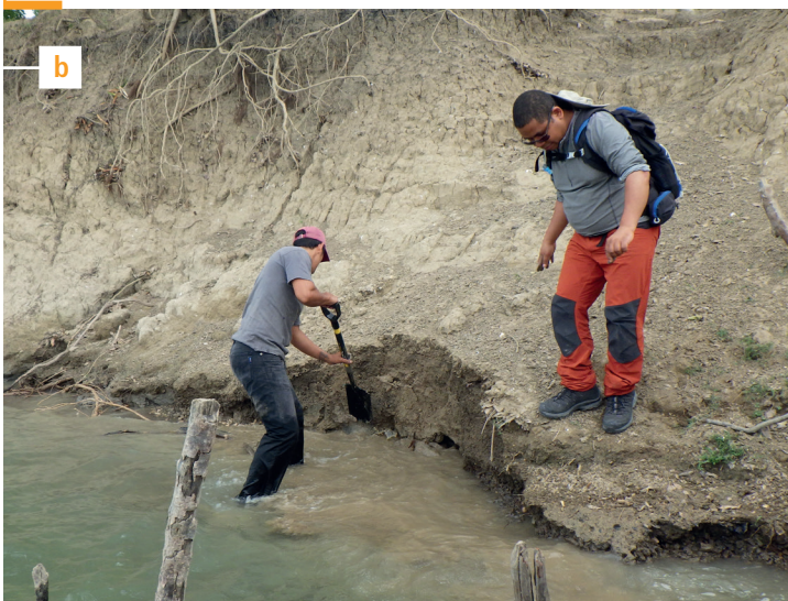
Figure 4.2 : Prélèvements manuels des sédiments de l'Usumacinta : (a) avec cône, (b) avec pelle, (c) avec seau. © I. Djeran-Maigre, avril 2018.
