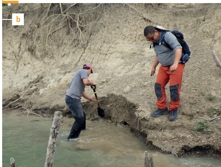
Figure 4.2 : Prélèvements manuels des sédiments de l'Usumacinta : (a) avec cône, (b) avec pelle, (c) avec seau. © I. Djeran-Maigre, avril 2018.
