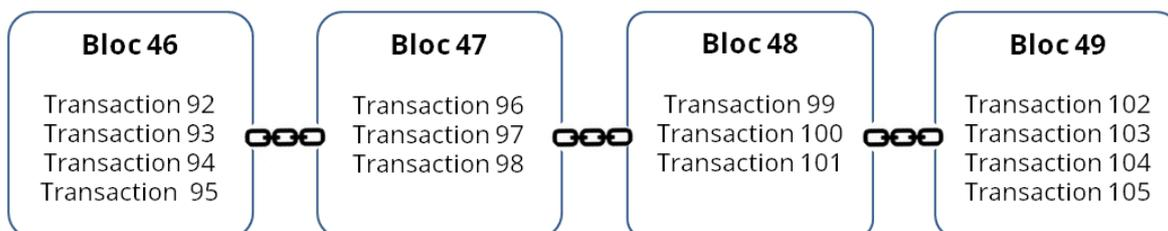
**Figure 1 - Chaîne de blocs (Blockchain France, 2016)**
