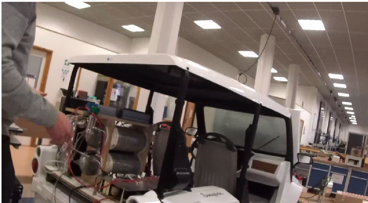
Figure 6. Véhicule hybride assemblé par les étudiants de l'UTBM. Bien visibles à l'arrière du véhicule, les bombonnes de stockage hydrogène sont vides, car les normes de sécurité interdisent de stocker de l'hydrogène à haute pression à l'intérieur d'un bâtiment.
