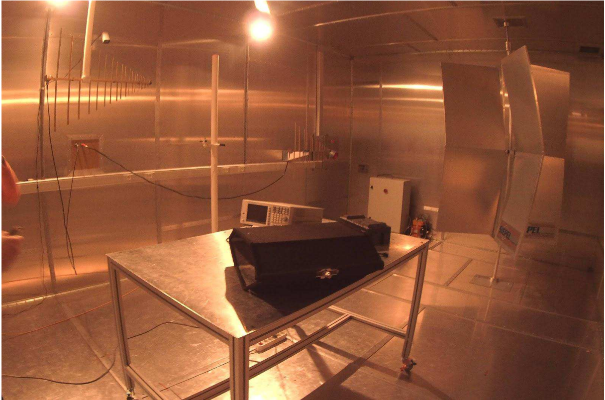
Figure 3. Dans une cage de Faraday. A droite le brasseur d'onde. Cellule de compatibilité électromagnétique, Université de technologie de Belfort-Montbéliard. 08/02/2016.
